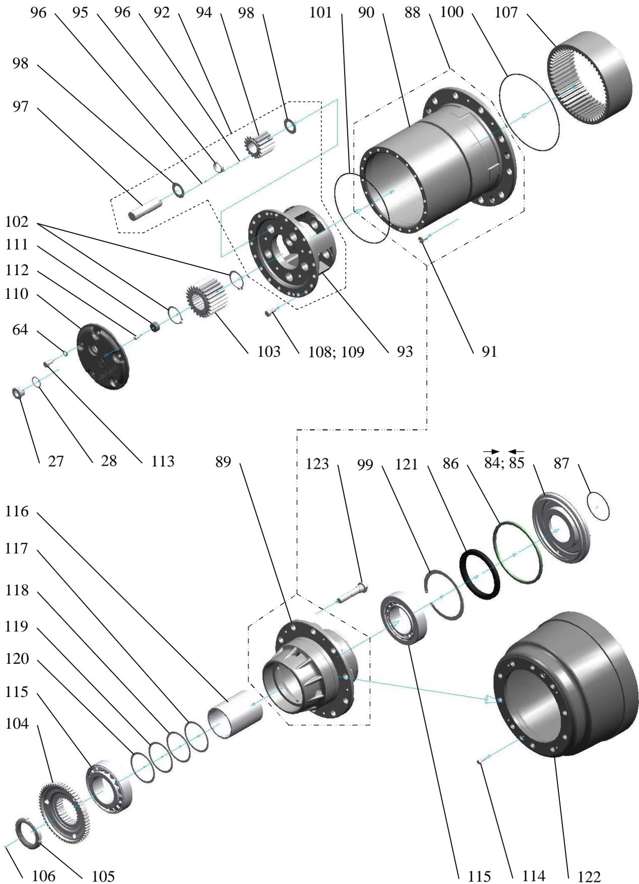
*Задний ведущий мост "МАДАРА" 318.7 самосвала "КАМАЗ" 53605 и задний ведущий мост
