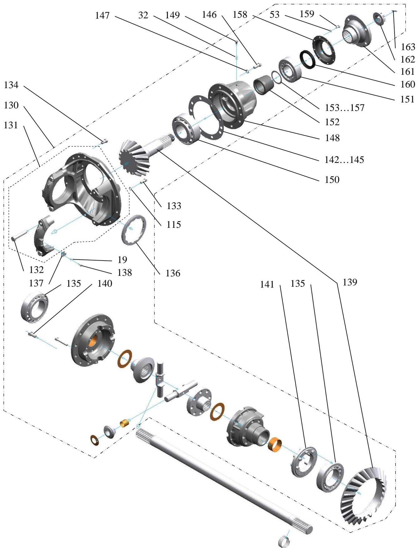
*Задний ведущий мост "МАДАРА" 318.7 самосвала "КАМАЗ" 53605 и задний ведущий мост
