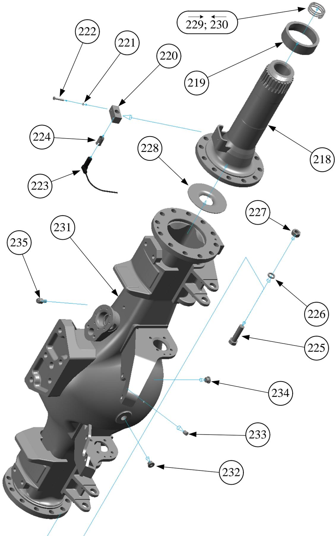
Передний, средний и задний ведущие мосты "МАДАРА" для автомобиля "КАМАЗ" 6522 – Каталог запасных частей
